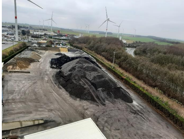
Foto 1 : Voorraden grondstoffen en freesasfalt op de Ascovil site
